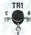
Fig. 4 Il transistor TR1 andrà montato dal lato rame, collocando il collettore (terminale più lungo) verso sinistra.
