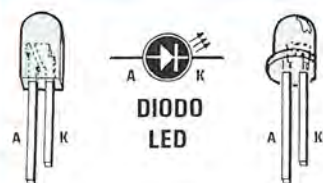
Fig. 2 Disegno a grandezza naturale del circuito stampato e connessioni del diodo led.
